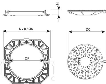
**Punto está diseñada para soportar un tráfico suave.** Perfecta para instalar en vías con una IMD de 500 a 1.000, especialmente calzadas de carreteras (incluyendo calles peatonales), arcnos estabilizados y zonas de aparcamiento para todo tipo de vehículos.
