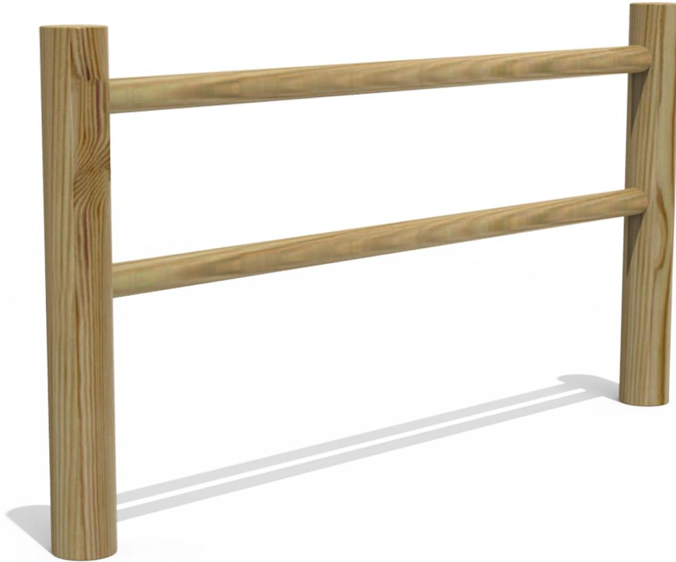
Valla fabricada en madera de pino con tratamiento autoclave a vacío-presión clase 4 contra la carcoma, termitas e insectos. Postes de Ø 120 x 1500 mm. Travesaños de Ø 80 x 2000mm.
