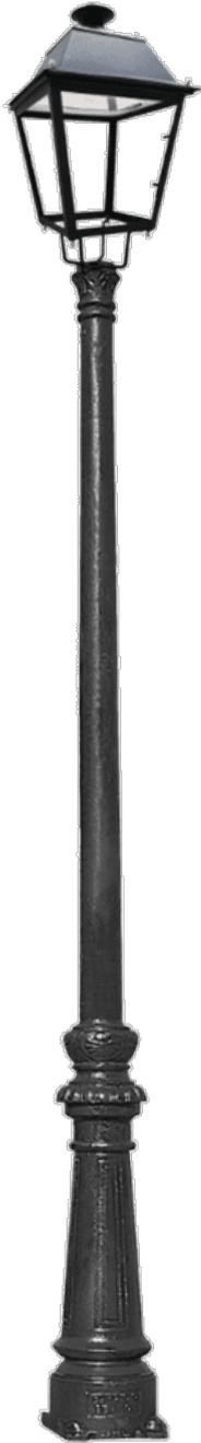
Leuchtmast für Wohngebiete, Fußgängerzonen, Altstädte und Wohnkomplexe. Schaft aus Duktguss und Mast aus feuerverzinktem Stahl in Qualität S-235-JR galvanizado en caliente. Mit Epoxyd-Primer und Pulverbeschichtung in Schwarz. Buchsenanschluss 3/4"; Verschraubung wird nicht mitgeliefert
