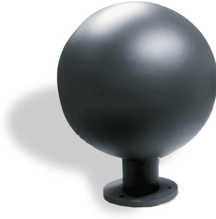
Borne fabriquée en acier avec traitement Ferrus, procédé qui protège le fer et garantit une résistance optimale à la corrosion. Le traitement Ferrus consiste en trois couches appliquées à la suite du nettoyage de toutes les impuretés par grenailage : zingage, couche époxy et une couche de peinture poudre polyester teinte noir forge.
