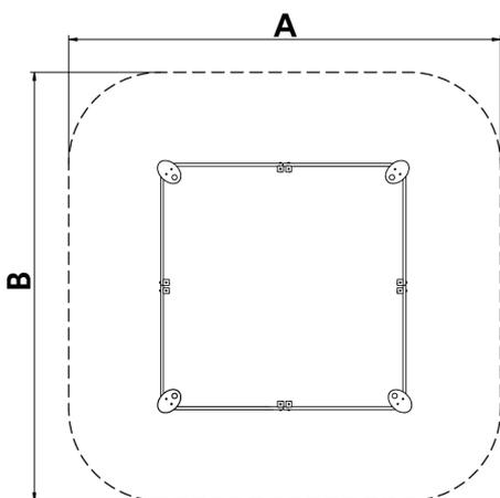
**Structure, Bois lamellé :** bois de pin scandinave traité en autoclave classe IV. Finition avec 2 couches de peinture Lasur. Face aux intempéries, le bois laminé peut présenter de petites fentes qui ne réduisent pas sa durabilité. La résine et les noeuds sont naturels.
