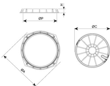
**HRM D4 è progettato per supportare un traffico leggero.** Perfetto per essere installato su strade con un ADT di 500-1.000, specialmente per carreggiate stradali (incluso le vie pedonali), banchine e le aree di sosta per tutti i tipi di veicoli.
