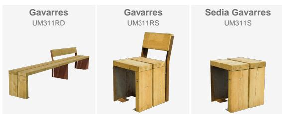
Panca realizzata con un laterale in lastra di acciaio Corten con spessore 8 mm e doghe di legno di pino trattato in autoclave, rischio classe IV, con sezione di 210 x 58 mm, con protezione contro tarli, termiti ed insetti.
