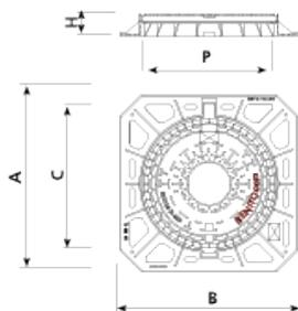
**Kerkus está diseñada para soportar un tráfico medio.** Perfecta para instalar en vías con una IMD de 1.000-20.000, especialmente calzadas de carreteras (incluyendo calles peatonales), arcenes estabilizados y zonas de aparcamiento para todo tipo de vehículos.
