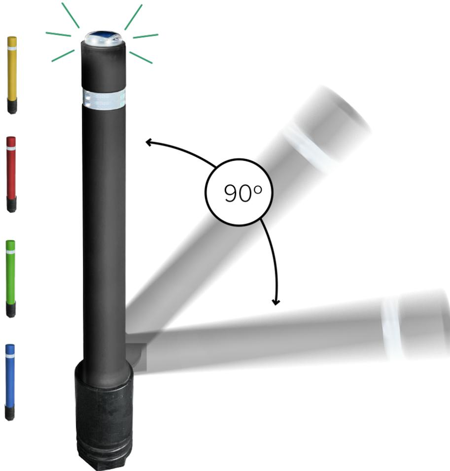
Beweglicher Poller mit Solar-LED-Leuchtring aus schwarzem Polyurethan, wahlweise in rot, blau, gelb oder grün. UV-geschützt, ein Reflektorenband. Mit aufschraubbarer Bodenplatte Beständig gegen Aufprall von Fahrzeugen, kehrt zu 100% in seine Originalform zurück. Hält bis zu 1500 Biegungszyklen zu 45° und 50 Zyklen zu 90° schadenfrei aus. Klassifizierung "E" Feuerbeständigkeit gemäß UNE-EN 13501-1:2007+A1:2010. Beständig bis -50° gemäß Norm UNE ISO 812. Wartungsfrei.
