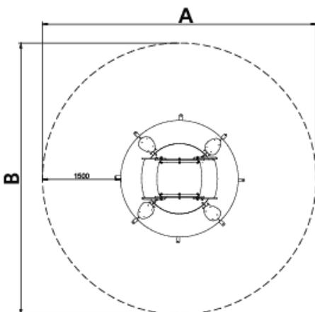
Struktur, Metall: Pfosten mit Durchmesser 35mm aus AISI304 Edelstahl, extrem korrosions- und witterungsbeständig. Die Rutsche besteht aus poliertem AISI304 Edelstahl in 2 mm Stärke, aus einem Teil gewellt und geformt.
