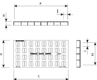
Tango D4 está diseñada para soportar un tráfico intenso. Perfecta para instalar en vías con una IMD de 1.000-20.000, especialmente calzadas de carreteras (incluyendo calles peatonales), arcenes estabilizados y zonas de aparcamiento para todo tipo de vehículos.
