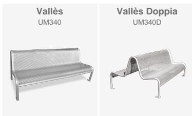
Panca realizzata con laterali in tubolari di acciaio curvati di Ø40 mm, con seduta in modulo continuo realizzata in lamiera di acciaio forata spessore 2 mm, con fori circolari alternati del diametro pari a 7 mm, trattata con Ferrus, un processo protetto alla corrosione.
