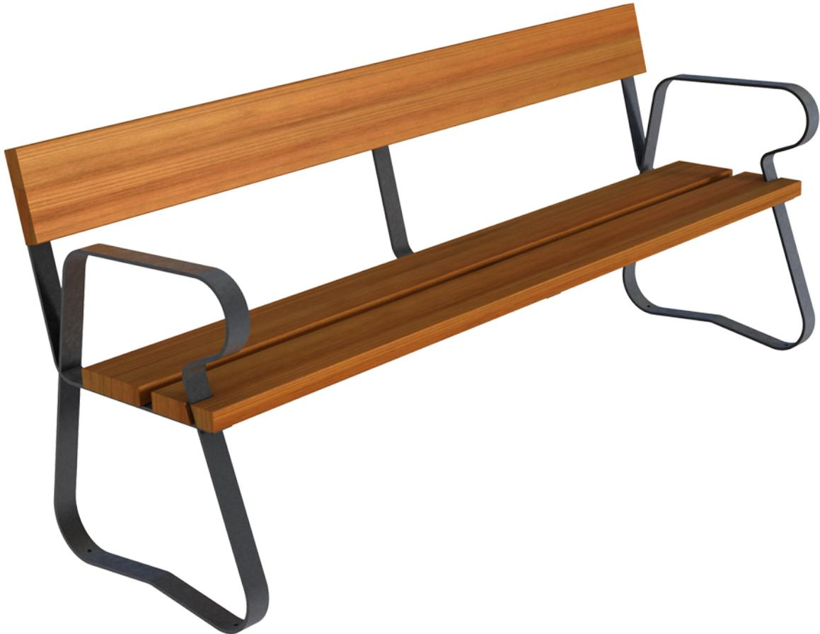
Banco fabricado con pies y refuerzo central de pletina de acero de 50 x 8 mm (UM332: 50 x 16 mm) tratado con Ferrus, un proceso protector del hierro, que garantiza una óptima resistencia a la corrosión.
