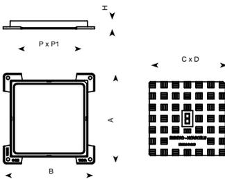
Hidra C2 está diseñada para soportar un tráfico suave. Perfecta para instalar en vías con una IMD de 500 a 1.000, especialmente en arcenes y cunetas.
